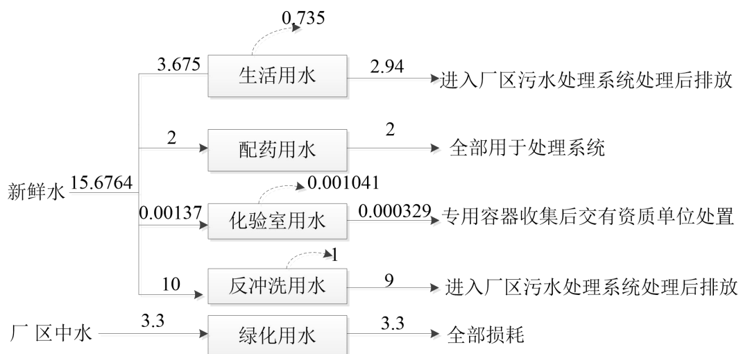
图2-2 本项目改建后全厂水平衡图 单位：m³/d
